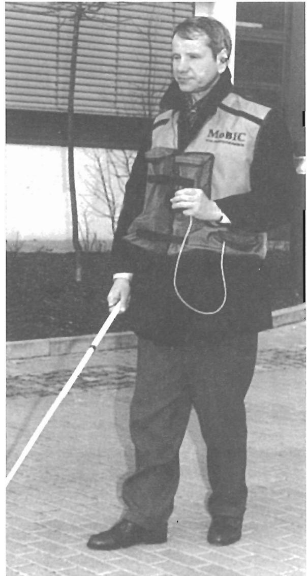
Fig. 1 Prototipus del sistema Mobic, pel guiat de deficients visuals i cecs.
