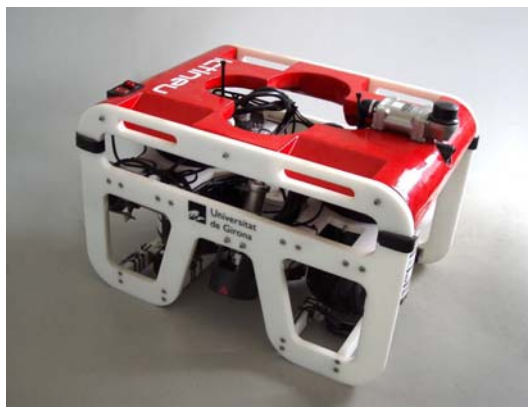
Fig 2. El robot ICTINEUAUV , anomenat així en homenatge a Narcís Monturiol, va ser el guanyador de la 1ª edició del SAUCE. Es tracta d'un robot amb quatre graus de llibertat, equipat amb 2 càmeres de vídeo, un sonar d'imatges, un altímetre acústic, un hidròfon, un sensor de velocitat per efecte doppler, una unitat de mesura de la orientació (3D), un compàs i un sensor de profunditat. El robot incorpora dos PCs, un per processar vídeo i imatges i l'altre responsable del control i de l'accés als sensors. També incorpora sensors per detectar fuites d'aigua així com per supervisar la temperatura i la pressió dels contenidors a pressió. El robot està dotat d'una arquitectura software distribuïda i orientada a objectes.
